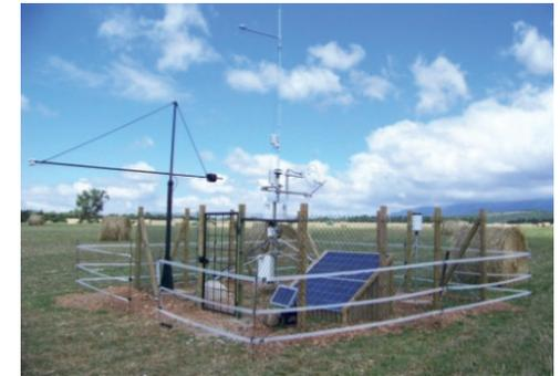
Estación española para la medición de flujos de carbono, agua y energía entre una parcela agrícola y la atmósfera
