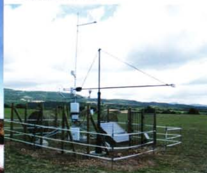
Figures 3 i 4: A baix, torre micrometeorològica FLUXPYR a Catalunya per a la medició en continu dels fluxos de carboni, aigua i energia entre el sòl i l’atmosfera, en una parcel·la agrícola: l’anemòmetre, analitza-dor infraroig de CO 2 i vapor d’aigua, pluviòmetre i radiòmetre són alguns dels instruments utilitzats. A l’esquerra, torre alta a la Muela mesurant en continu la concentració atmosfèrica de CO 2 i diverses variables meteorològiques (IC3)
