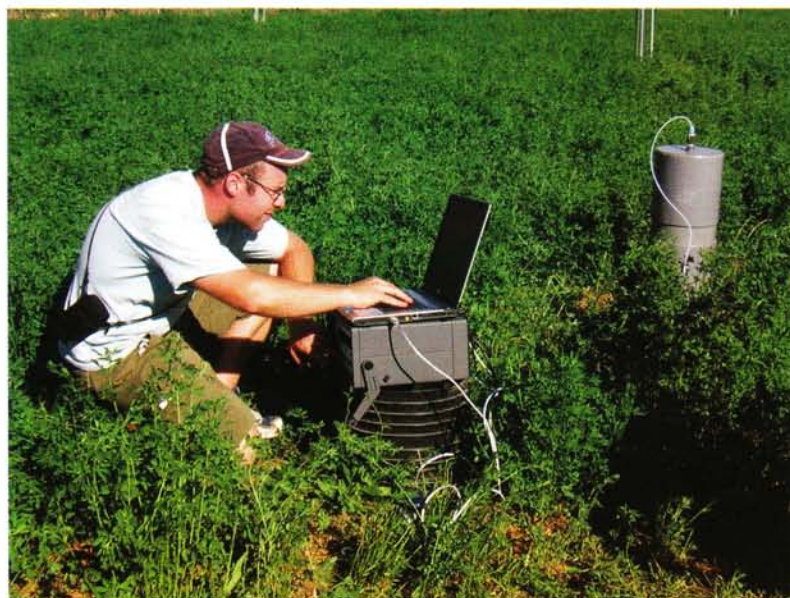
Figura 5: Mesures de les emissions de CO 2 , N 2 O i CH 4 amb un aparell fotoacústic en un camp agrícola amb diferents tractaments de diversitat i grups funcionals vegetals. Les taxes d'emissions s'acceleren després de la irrigació del camp, i quan la temperatura és més elevada.
